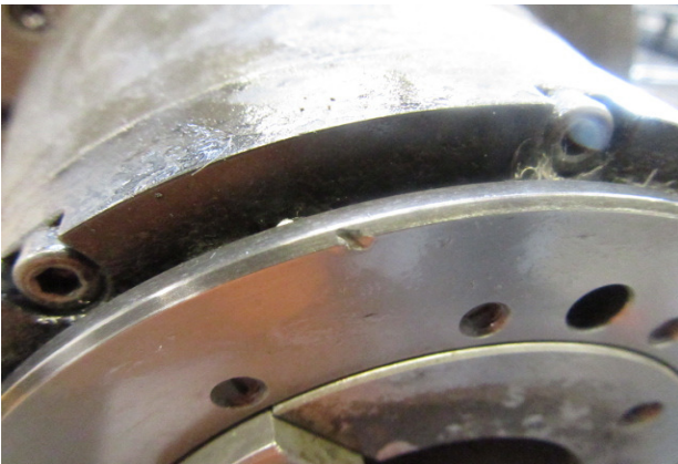
Wellenmutter ist beschädigt.
