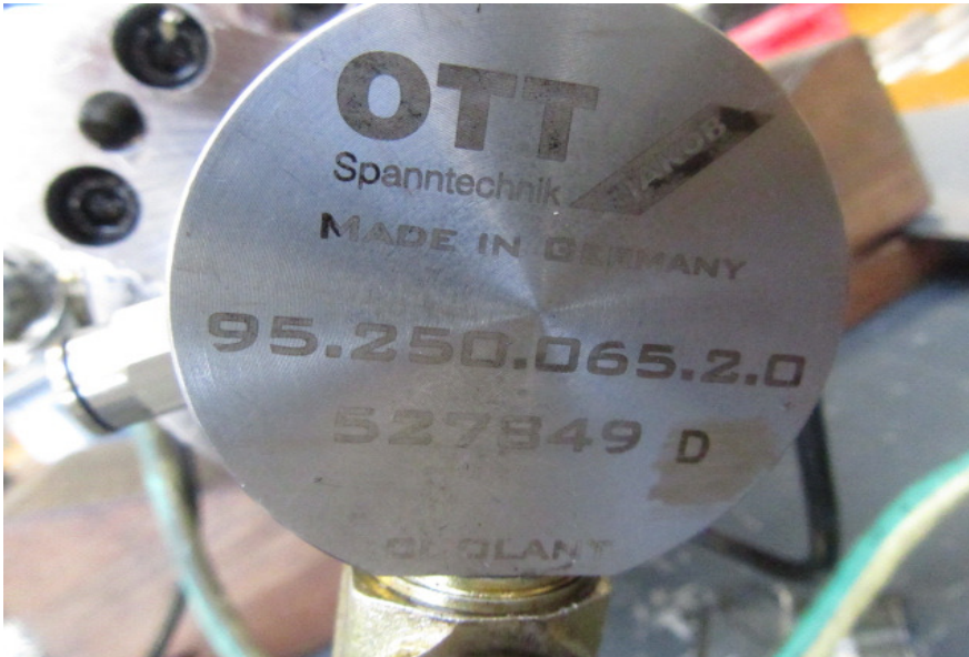
Bild 4.2: Makroaufnahme der Drehdurchführung / extreme close-up rotary of the transmission leadthrough / giunto rotante
