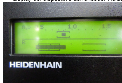
Bild 3.5: Makroaufnahme der Symmetriemessung / symmetrie test / test di simmetria
